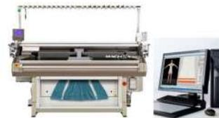
Máquina de tricô horizontal computadorizada "whole garment (peça inteira)" (Shima Seiki S.A.)
